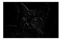
Edge Detection Filter:  $\begin{bmatrix} -1 & -2 & -1 \\ 0 & 0 & 0 \\ 1 & 2 & 1 \end{bmatrix}$
